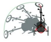
De par sa géométrie, un trike delta vire quasiment sur place – un vrai plus, pas seulement au moment de se garer.
