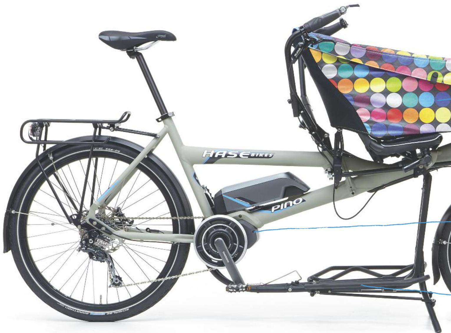
**PINO STEPS – caractéristiques techniques et équipement :** Longueur totale : 210–237 cm · Largeur totale : 64 cm · Hauteur totale : 104–110 cm · Hauteur d'assise avant : 64 cm · Hauteur pédalier avant : 62 cm · Empattement : 145 cm · capacité : 11,6 Ah, 418 Wh, tension : 36 V, puissance maxi : 250 W, nombre de cycles de recharge : 1000, tps de recharge : 4 h, autonomie : 50 km, env. Poids batterie : 2,55 kg, garantie batterie : 24 mois, déconnexion assistance à 25 km/h · **Bagages :**
